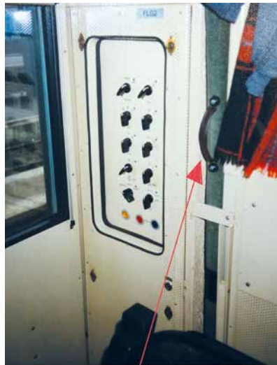
A vezetőállás hátfalából előhúzható heverő az ÖBB 1014-es mozdonyon.
