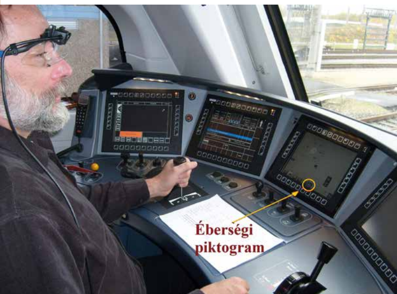
Az Alstom Prima 2 mozdonyán, mielőtt az éberségi megszólalt volna, a vezetőasztalon kigyulladt egy piktogram. Ha a mozdonyvezető ezt látván, azonnal cselekedett, a hangjelzés elmaradt.
